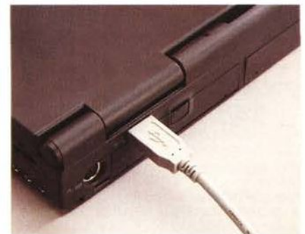
Tra le connessioni "per il mondo esterno" disponibili sul retro, la più interessante è la porta USB: permette il collegamento di ben 127 nuovi dispositivi esterni.
